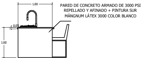
DETALLE DE COCINA LATERAL ESCALA .
